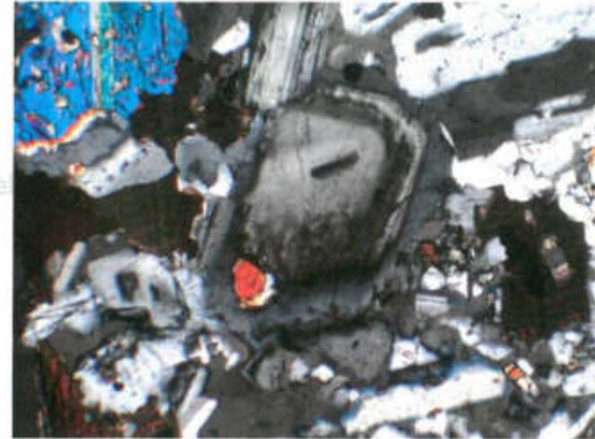
Abb. 1: DS VII-18. Durchlichtmikroskopische Aufnahme, Nic. +. In der Bildmitte ein zonar gebauter Plagioklas mit einem rotbraunen Augit- und einem nadeligen Apatiteinschluss. Links oben blaugrüner Augit. Bildbreite ca. 1 mm.
