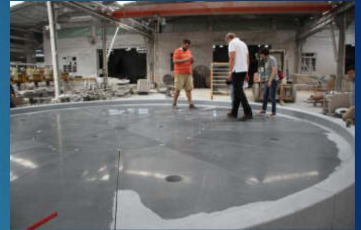
Jedes der Brunnensegmente wiegt 3,2 t. Mit einem Gesamtgewicht von ca. 60 Tonnen und einem Durchmesser von 6 m ist der Brunnen ein Musterstück an Präzision trotz enormer Größe.
